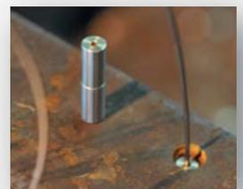
短い時間のミニミルの工程には、表面及び雰囲気測定のため、早い応答性と曲げやすさから直径2mmの熱電対が使用されます。
