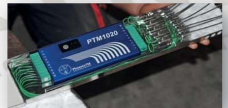
熱電対クランプを備えたログアレイは、データロガーの収納、取出しが容易です。
