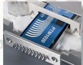
ステンレスのコンプレッションフィッティングは、水の浸入を防ぎ、熱電対を張力から守ります。
